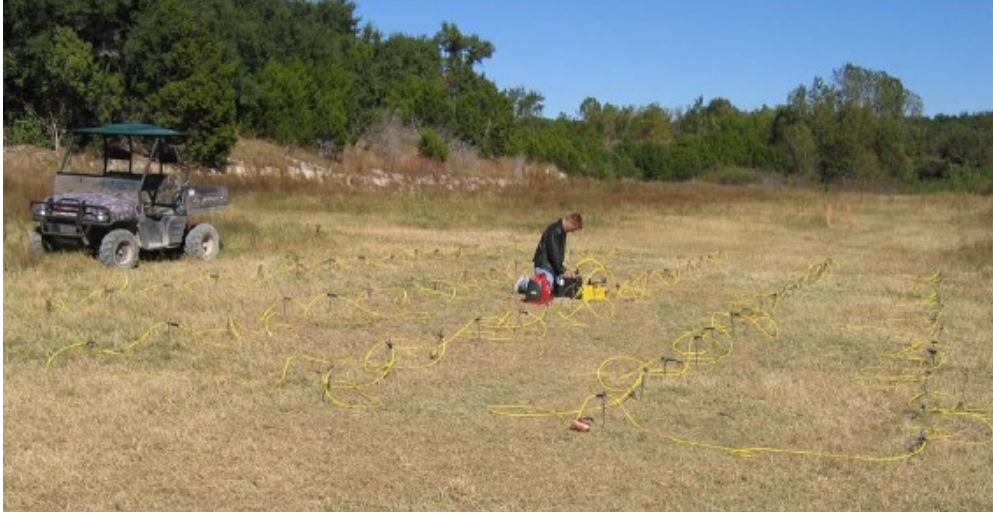
Şekil-4. Çok-elektrotlu elektriksel özdirenç yöntemi ile arazide ölçü alımı (www.agiusa.com)
