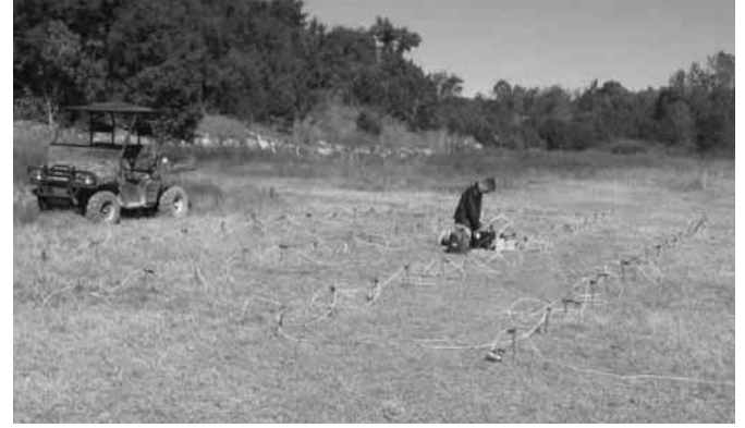
Şekil-5. Çok-elektrotlu elektriksel özdirenç yöntemi ile arazide ölçü alımı (www.agiusa.com)
