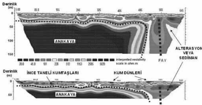
Şekil-11. Çok elektrotlu özdirenç ölçümü ile belirlenen bir fay (Bernard ve diğ.,2008)
